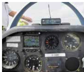
IM COCKPIT der ASK 21 finden sich Höhenmesser, Fahrtmesser, Kompass, GPS, Funkgerät und Variometer. Letzterer unterstützt den Segelflieger bei der Suche nach Thermik, indem er Steig- oder Sinkgeschwindigkeiten anzeigt.
